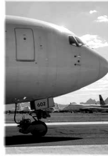
Démonstrateur du concept de roulage autonome sur Boeing B757 (Avril 2008) et projet d'intégration dans la roue
