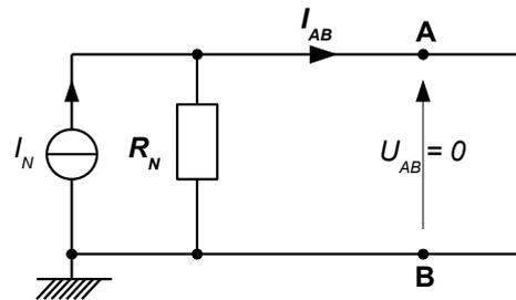
Figure 3.B : essai en court-circuit du générateur équivalent de Norton.
