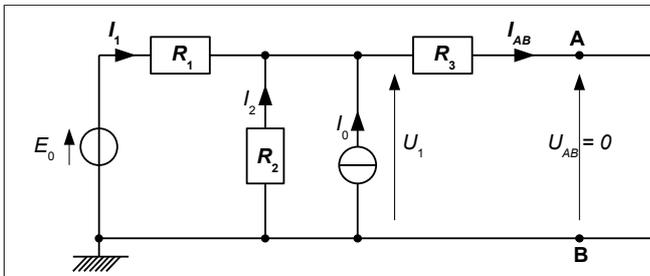
Figure 3.A : essai en court-circuit du circuit étudié.
