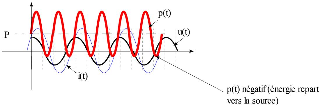
Ce graphe montre que par instant, la puissance devient négative et donc le transfert d'énergie se fait en sens inverse, du dipôle, vers la source. La puissance moyenne, est donc ( $T= 1/F$ ) :
