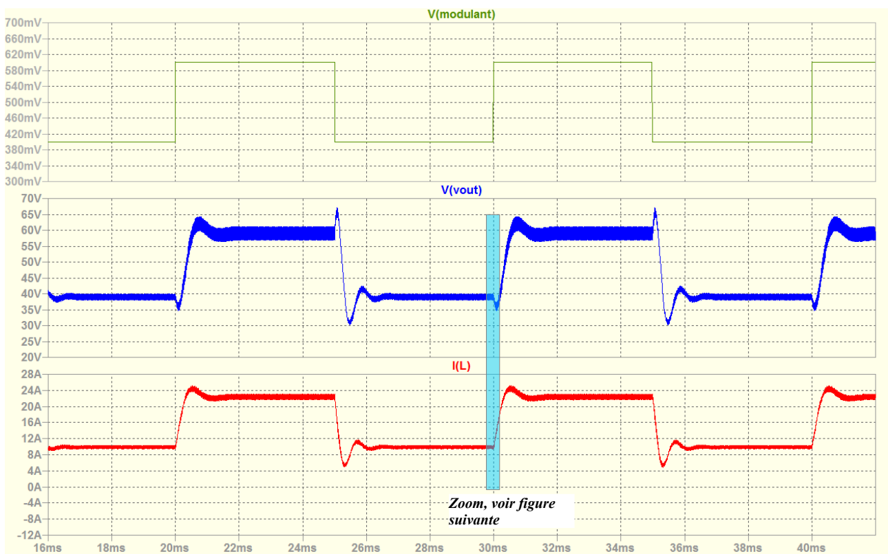
Fig 2.3 Evolution du rapport cyclique, de la tension de sortie et du courant dans l'inductance.
