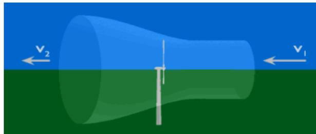
Figure 17 : Schéma d'écoulement de l'air dans une éolienne à axe horizontal non carénée, source [33]
