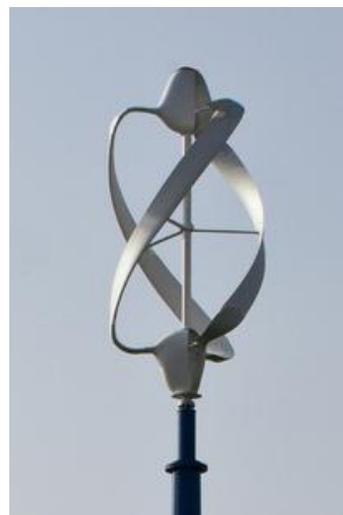
Figure 13 : Éolienne de type Darrieus<sup>5</sup> à rotor parabolique de 110 m de haut de 1983 à 1992, Parc Eole Québec, et éolienne de 6 kW combinant les technologies Darrieus et Savonius<sup>6</sup>, Noveol à Poitiers, sources [27] [28]
