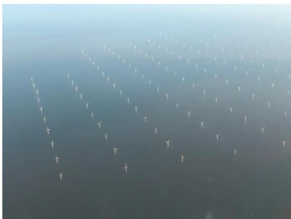
Figure 8 : Ferme éolienne de London Array (mise en service en 2013), puissance installée de 630 MW, production annuelle d'environ 2 TWh, source [22]
