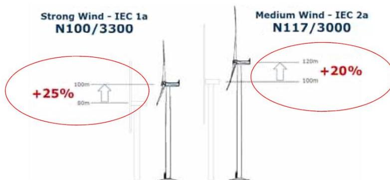
Figure 34 : Comparaison de production annuelle d'énergie de 2 machines N100/3300 et N117/3000 selon leur hauteur d'implantation, source [44]
