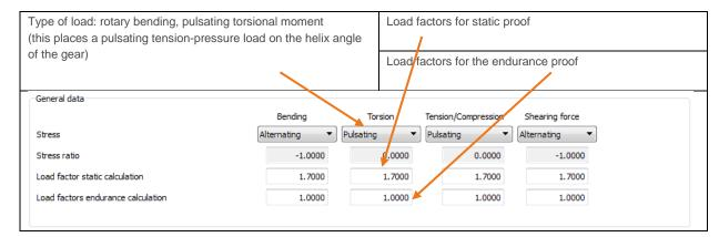
Figure 18. «Strength» tab: «General data» - details of the type of load
