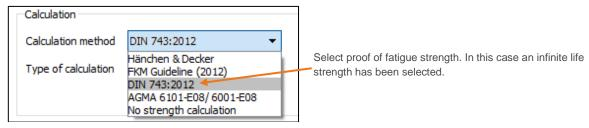
Figure 17. «Strength» tab: «Calculation» group - Details about the proof
