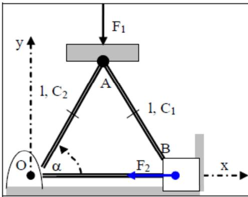
On appelle *levier à pression* le système de 2 tiges identiques (de même masse  $m$ ) articulées dont l'une a une extrémité immobile  $O$  et l'autre une extrémité  $B$  qui peut se déplacer suivant l'axe  $Ox$ .
