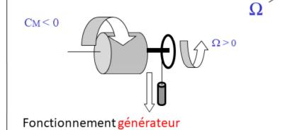
La notion de vitesse permet de calculer la **puissance fournie ou à fournir**. La puissance en mécanique se calcule par le produit
