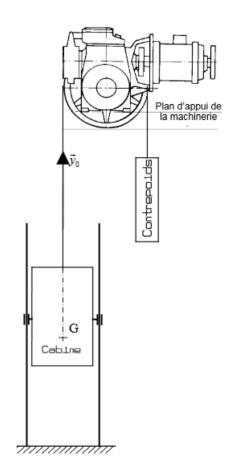
**Exercice:** Calculer la puissance nécessaire pour déplacer à vitesse stabilisée de 2 m/s une cabine d'ascenseur hydraulique ou électrique.
