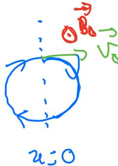
Démo: PFD:  $m\vec{a} = q(\vec{v}_0 \wedge \vec{B})$  des  $P_0$  base de Frenet.
