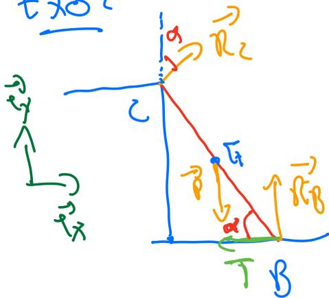
1) bilan des forces: Poids, les réactions du sol  $R_B$  et du mur  $R_C$  + tension du fil attaché en B
