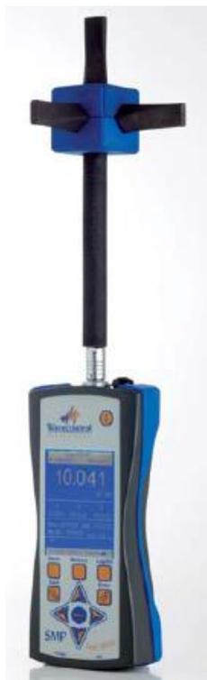
Wavecontrol– Mesureur de champ (500 KHz – 3 GHz)
