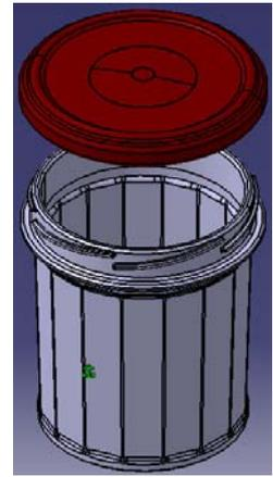
Pour lier verticalement le pot et son couvercle, il n'est pas possible d'utiliser la coïncidence à nouveau à cause de la forme de notre couvercle qui ne possède pas de surface plane.
