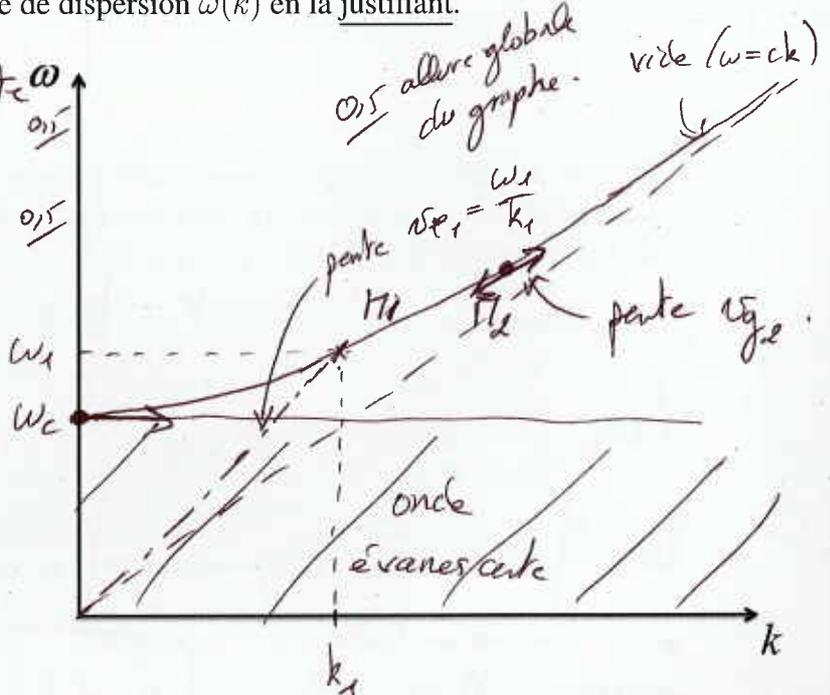
7. Exprimer la vitesse de phase  $v_p$  et la vitesse de groupe  $v_g$  de l'onde progressive en fonction de  $c$  et des pulsations caractéristiques du plasma. Indiquer en un point de la courbe de dispersion ci-dessus comment les identifier graphiquement.
